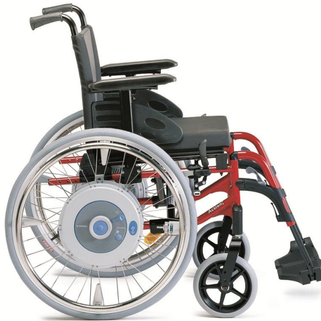
Figure 2 : Fauteuil roulant à assistance électrique avec roues M12 d'Alber
