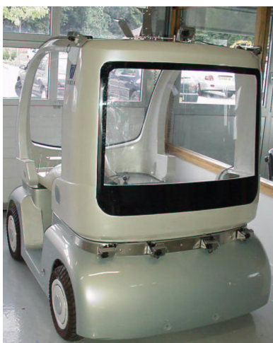
Figure 12: emplacement des capteurs sur le robot
