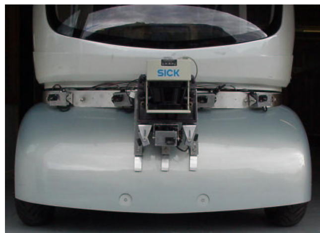
Figure 12: emplacement des capteurs sur le robot
