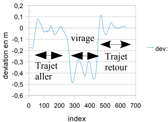
déviaton laterale avec filtrage Kalman K_p=0.5; K_d=0.5; V=1\text{ m/s}; R=0.05
