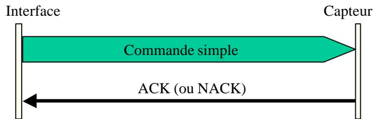
**Figure IV.2.5.a : Commande simple**
