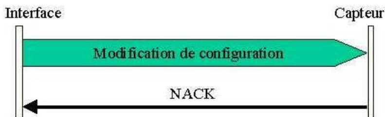
**Figure IV.2.5.c : Commande avec mauvais CRC**
