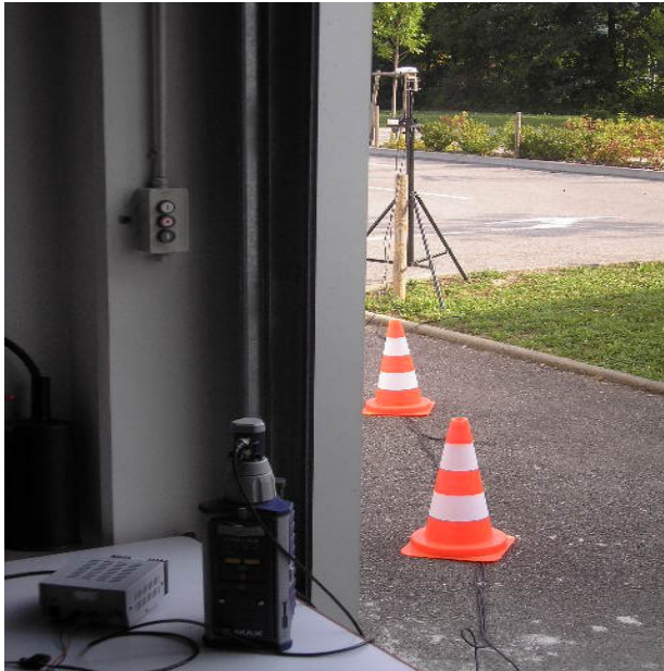
Illustration 8: Photographie du montage GPS fixe
