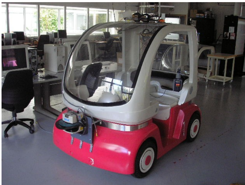
Illustration 15: Photographie du Cycab équipé du GPS
