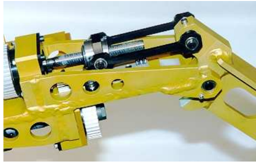
FIG. 1.14 – Système de transmission du genou
