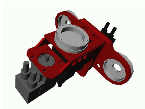
FIG. 2.2 – Exemple de fichier .iv importé pour construire le robot en open Inventor
