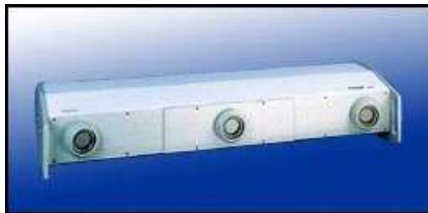
FIG. 3.1 – Les 3 objectifs CCD de l'OPTOTRAK
