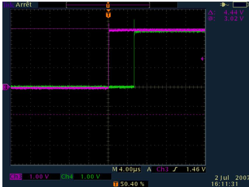
FIG. 10.2 – Mesure de temps avec l'oscilloscope et le générateur de fréquences, la tâche dure environ 5.6us
